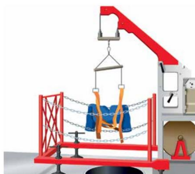
Aufbau einer Siloeinfahrereinrichtung
