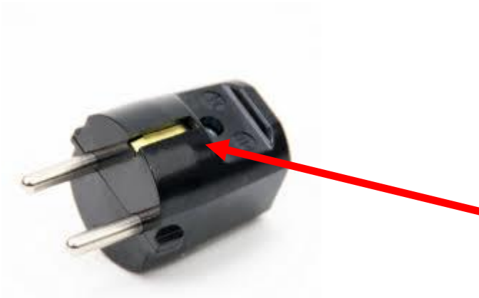
Beispiel eines nicht geeigneten Anschlusssteckers an einem Handgerät da dieser keinen Wasserabweisenden Schutzkragen besitzt.
